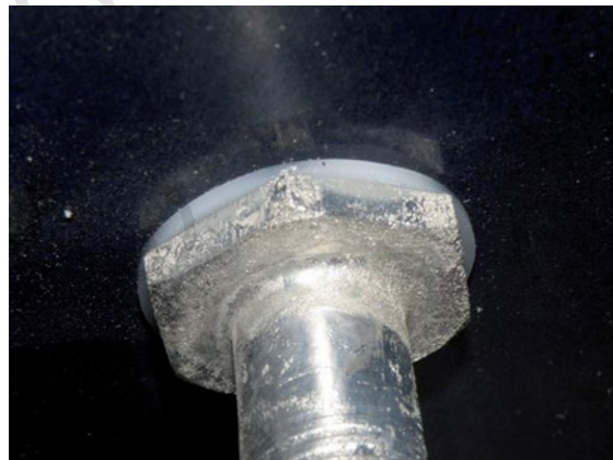
Detail izolačního oddělení měděné topné vložky od příruby „Nádoby“
