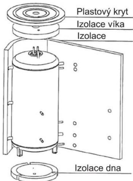
Izolace NEODUL LB PP o síle 100mm (1500 l), 120 mm (2000 l). Součástí jsou horní kryt, kryt přírub a krytky otvorů. Izolace se dodává samostatně zabalena.
