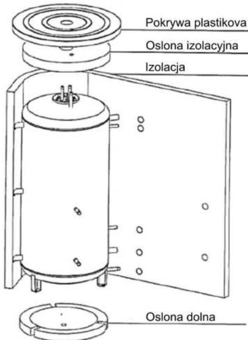
Izolacja NEODUL LBPP o grubości 100mm (1500 l), 120 mm (2000 l). Część składową tworzy pokrywa górna, pokrywa kołnierzy oraz pokrywki otworów. Izolacja dostarczana jest w osobnym opakowaniu.
