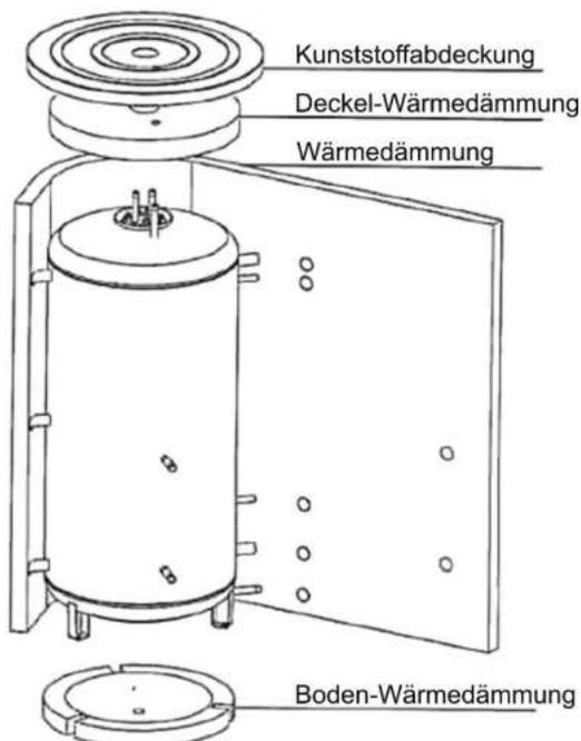
Isolierung NEODUL LB PP mit einer Stärke von 100mm (1500 l), 120 mm (2000 l). Bestandteil sind der obere Deckel, die Flanschabdeckungen und die Öffnungskappen. Die Isolierung wird eigenständig verpackt geliefert.
