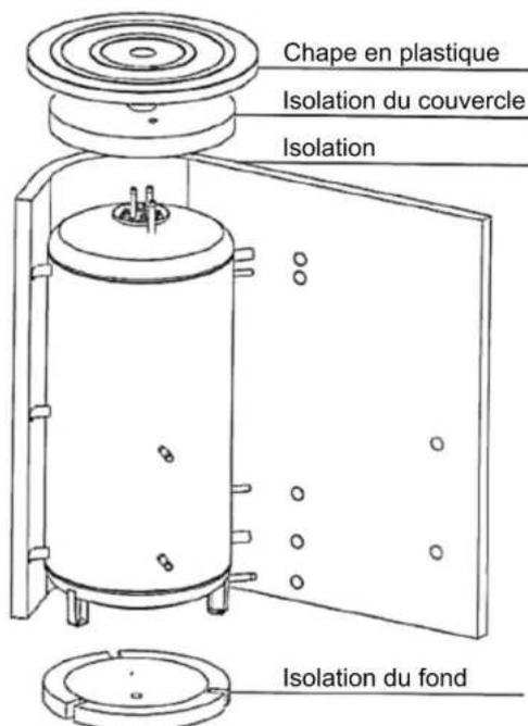
Isolation NEODUL LB PP d'une épaisseur de 100 mm (1500 l), 120 mm (2000 l). Le couvercle supérieur, le couvercle des brides et les bouchons des orifices en sont des éléments constitutifs. L'isolation est livrée emballée séparément.
