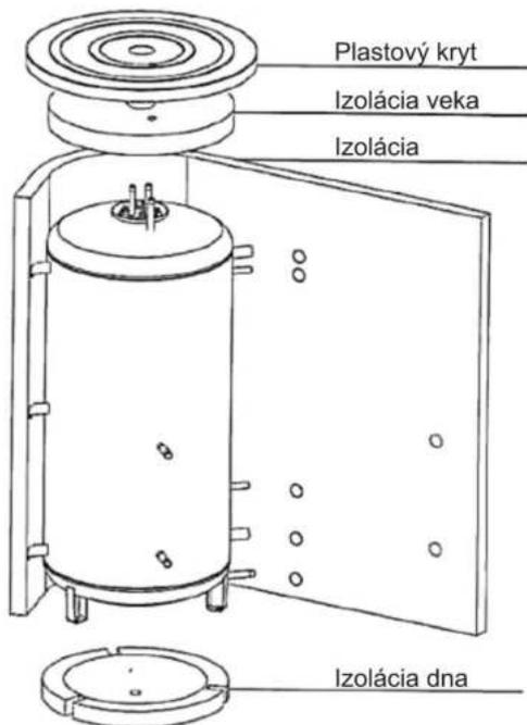
Izolácie NEODUL LB PP s hrúbkou 100 mm (1500 l), 120 mm (2000 l). Súčasťou sú horný kryt, kryt prírub a kryty otvorov. Izolácia sa dodáva samostatne zabalená.
