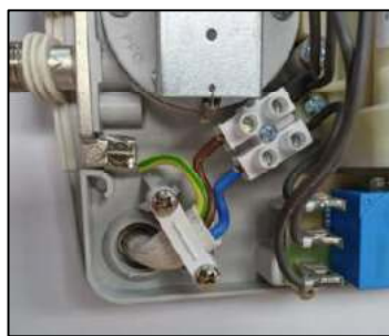
Príklad zapojenia 230V
