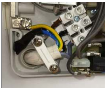
Příklad zapojení 3 x 400 V
