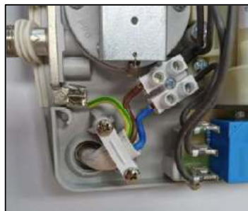
Příklad zapojení 230 V
