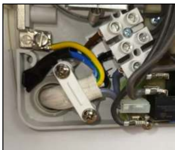
Príklad zapojenia 3x400V
